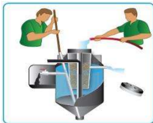
Limpieza: Esquema de limpieza de Biodigestor.
